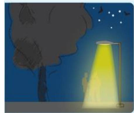
Gute Lichtlenkung: Die Lampe leuchtet direkt von oben nach unten und in der Höhe optimal angepasst genau dort, wo das Licht tatsächlich benötigt wird.
